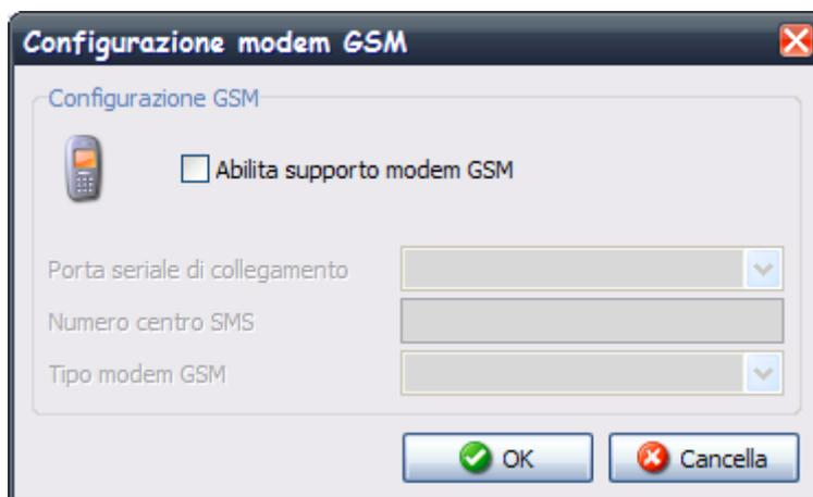
Abilita supporto modem GSM: abilita o disabilita il supporto modem GSM. Se si disabilita, Pvmon non può inviare SMS.
